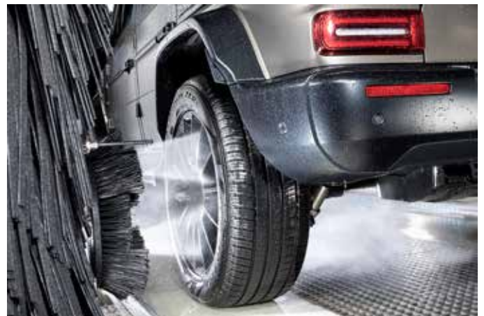
Opcional: Sistema de alta presión para las ruedas con 2 o 4 boquillas giratorias
