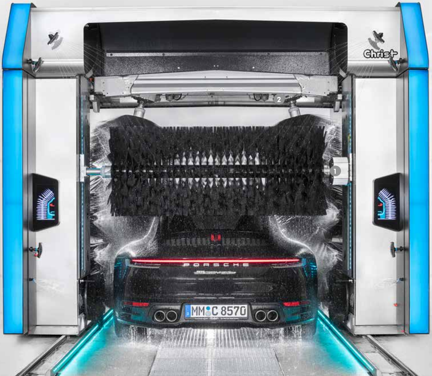
1. Accionamiento directo del rodillo horizontal 2. Accionamiento directo del rodillo lateral
